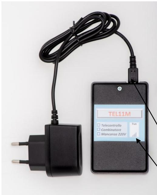
Tramite un telefonino togliere il PIN CODE e SEGRETERIA alla **MICRO\_SIM**, inserirla nel telecomando. Svitare la vite e aprire la scatola, inserire la SIM come da figura sotto (**ATTENZIONE la TACCA COME IN FIGURA**), spingere la SIM a fondo, (fino a filo del Porta SIM).
