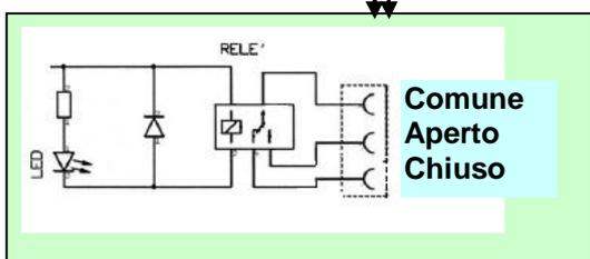
NB: Occorre tenere presente che la tensione di lavoro e la corrente dei carichi rispetto alle specifiche dei relè a bordo del sistema TELXXC vedi caratteristiche elettriche
