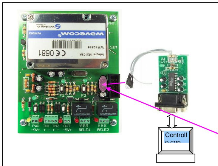
Il TELxxC ha a bordo un connettore per il collegamento seriale ad un PC tramite un circuito convertitore di livelli elettrici da TTL a V28.
