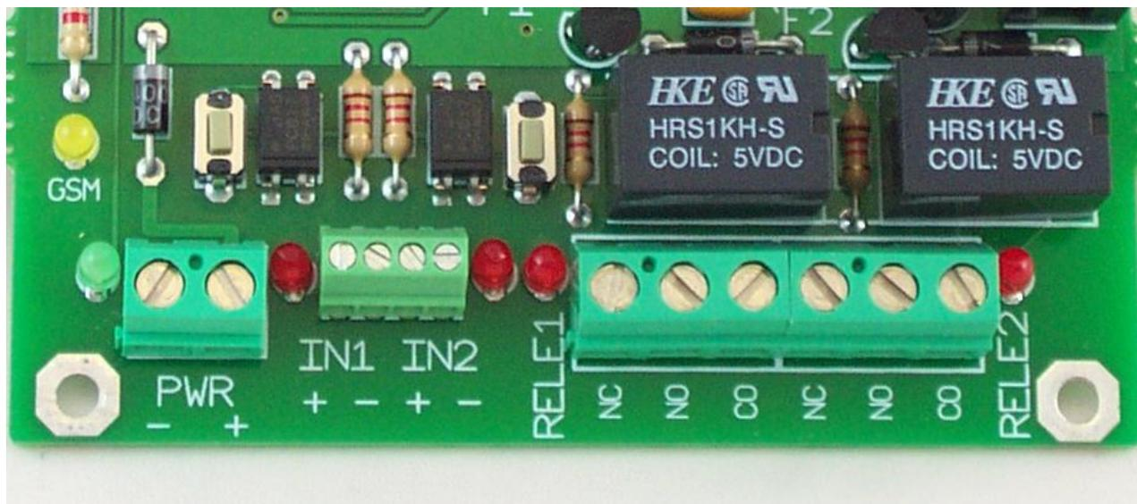
Tutti i collegamenti al modulo sono tramite morsetti a vite.
