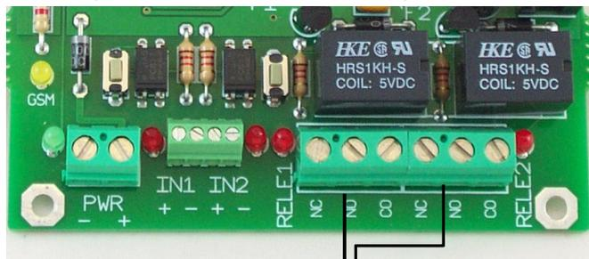
Le uscite dei relè, sono dei contatti di scambio. L'utente può scegliere di utilizzare il contatto chiuso o aperto in funzione del circuito che deve realizzare.
