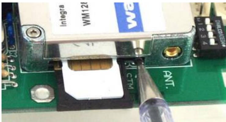
Prima di inserire la SIM nel modulo occorre che sia stata disabilitata la funzione PIN della SIM stessa, e che sia abilitata dal gestore di telefonia, per fare questo si può inserire la SIM in un telefono normale e verificare che funzioni.
